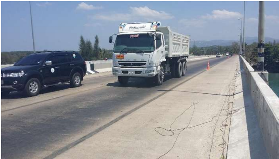
รูปที่ 4.4-1 ตัวอย่างรถบรรทุก 3 เพลา 6 ล้อ ยาง 10 เส้น ที่นำมาพิจารณาการสั่นไหวของสะพาน
