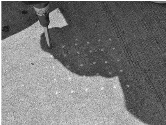
รูปที่ 1.3-3 ตัวอย่างการทดสอบกำลังรับแรงอัดของคอนกรีตโครงสร้าง
