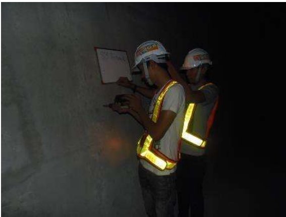
รูปที่ 1.3-3 ตัวอย่างการทดสอบกำลังรับแรงอัดของคอนกรีตโครงสร้าง
