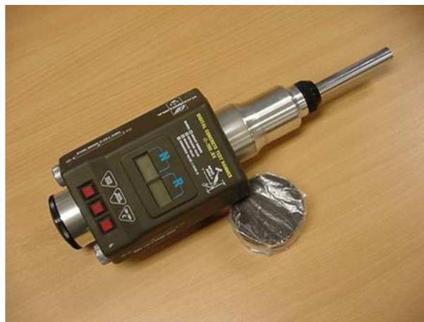
รูปที่ 3.1-1 เครื่องมือทดสอบกำลังรับแรงอัดคอนกรีต Rebound Hammer
