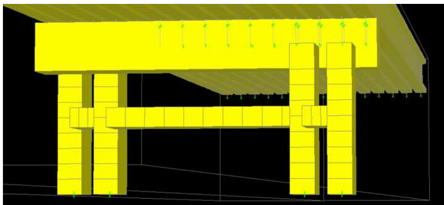
รูปที่ 6.8-5 ตัวอย่างแบบจำลองของ Piers สะพานเทพกระษัตรี (3D Extruded View)
