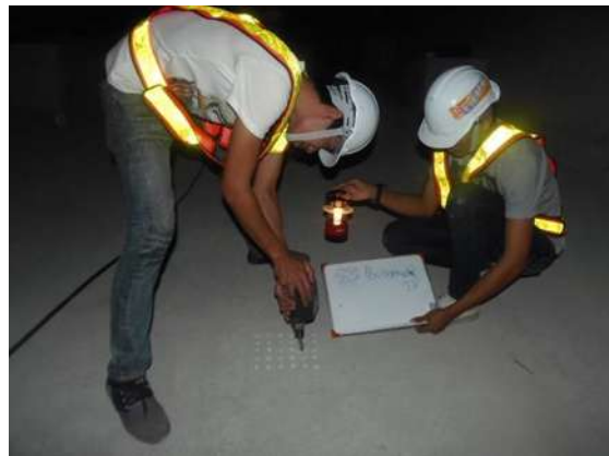
(ข) การทดสอบ Rebound Hammer
